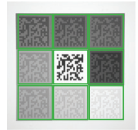
Durch HDR+-Technologie liest der DataMan 470 eine größere Bandbreite an Codes, die mit konventioneller oder HDR-Technologie nicht gelesen werden könnten.
