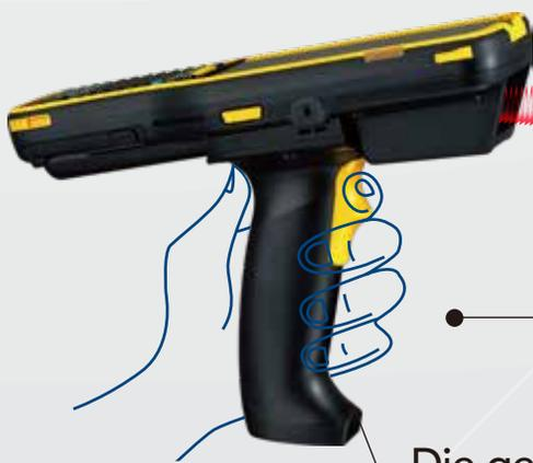
Ablezen eines Barcodes über eine Entfernung von maximal 21 m.
